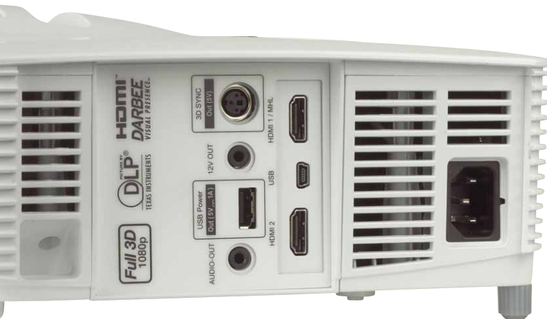
Einer der HDMI-Eingänge ist MHL-fähig, kann somit auch direkt vom Tablet oder Smartphone gefüttert werden, der Audio-Ausgang kann zum Beispiel einen Soundbar ansteuern
