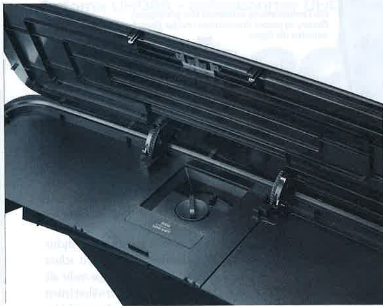
Fast schon ein Markenzeichen der aktuellen UHD-Reihe von Optoma; die Klappe, unter der sich Lensshift und Zoom verstecken, fokussiert wird vorn am Objektivring
