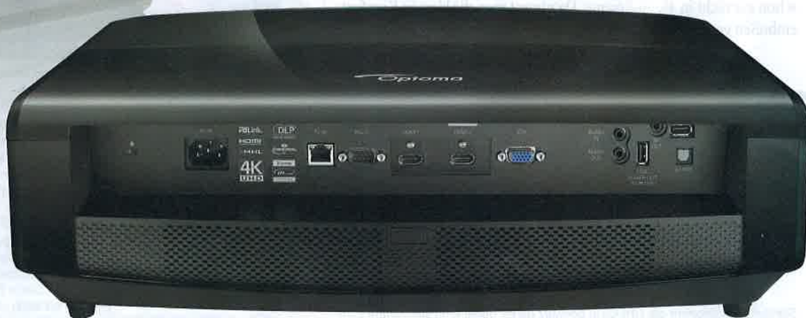
Die USB-Schnittstelle (rechts) steht unter Strom, um etwaige HDMI-Dongle direkt am Beamer zu versorgen
