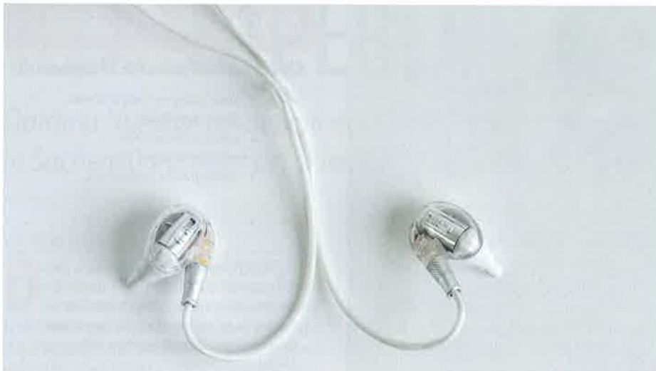
Das Kabel des HEM Dynamic ist vor den Ohrteilen abgerundet, sodass es problemlos über die Ohren geführt werden kann.
