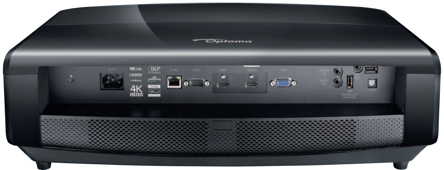
Optoma stellt besonders viele Optionen zur smarten Steuerung bereit. Neben zweimal HDMI gibt es die Analogoption VGA.
