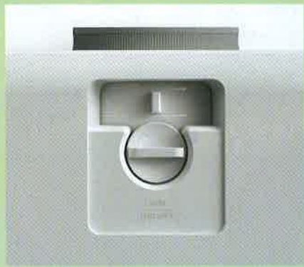
Der mechanisch minimalistische Lensshift bietet zu wenig Spielraum. Viele LCD-Projektoren offerieren diesbezüglich mehr Flexibilität.
