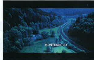
Wirkung und Nebenwirkung: Der UHZ65 reduziert mit „Dynamic Black“ die Leistung in dunkleren Szenen. Der Kontrast steigt, aber auf Kosten der Farbneutralität.
