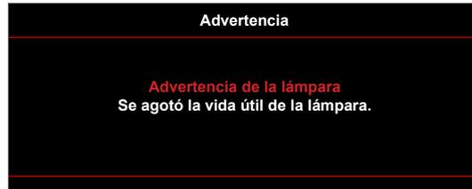
Cuando aparezca este mensaje, póngase en contacto con su distribuidor local o con el centro de servicio local para cambiar la lámpara tan pronto como sea posible. Asegúrese de que el proyector se ha enfriado durante al menos 30 minutos antes de cambiar la lámpara.
