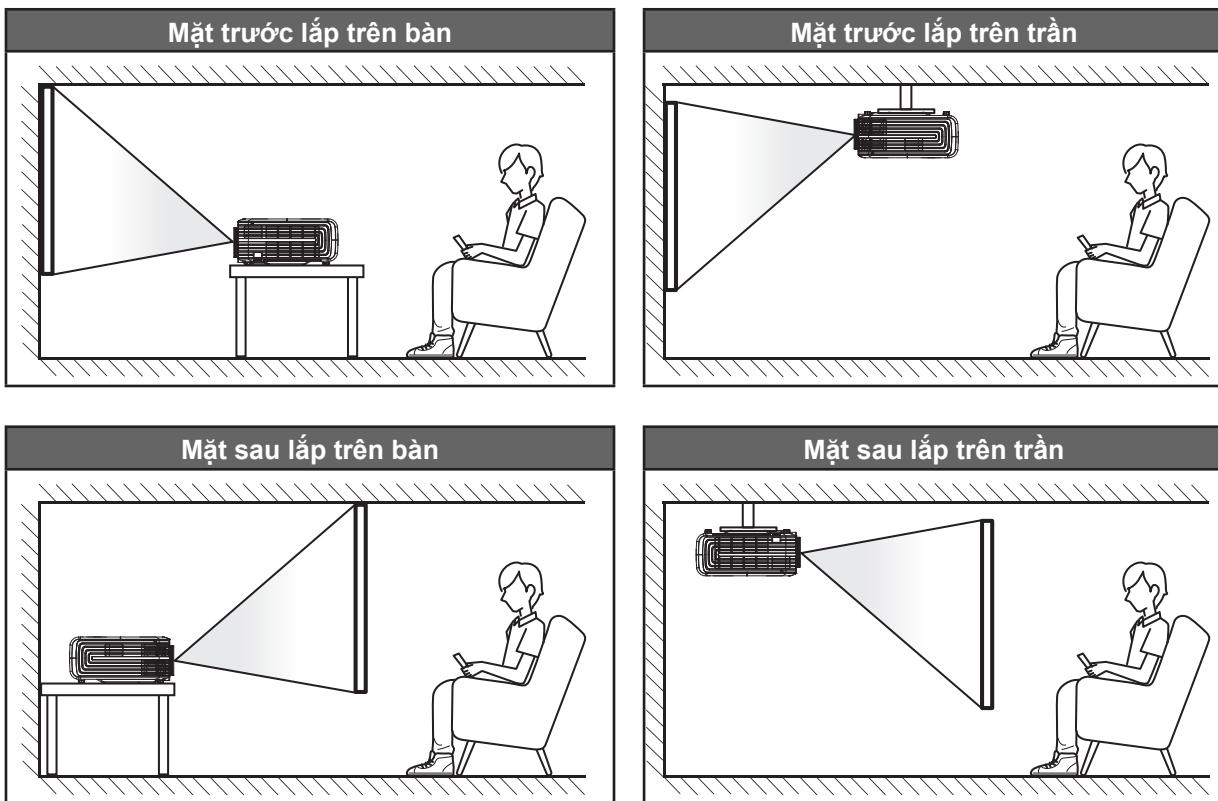
Phải đặt máy chiếu bằng phẳng trên bề mặt với một góc 90 độ và vuông góc với màn hình.
