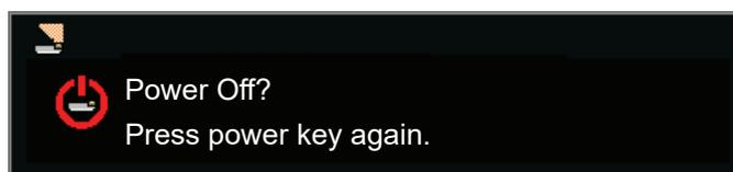
2. 按下投影機鍵盤上的「⏻」或再次按下遙控器上的「●」確認，否則警告訊息在 10 秒後將消失。當您第二次按下投影機鍵盤上的「⏻」或按下遙控器上的「●」後，投影機將關閉。
