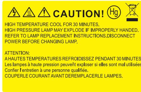
تحذير: يرجى توخي الحذر عند فتح لوحة الوصول إلى المصباح إذا كان جهاز العرض مثبتًا بالسقف، كما يوصى بارتداء نظارات الحماية عند استبدال المصباح، عندما يكون الجهاز مثبتًا بالسقف. يرجى اتخاذ الاحتياطات اللازمة لمنع سقوط أي أجزاء غير محكمة الربط من الجهاز.
