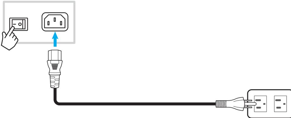
Tryck på **strömbrytaren** för att slå på skärmen. LED-indikatorn lyser blått, vilket indikerar att den är redo för användning.
