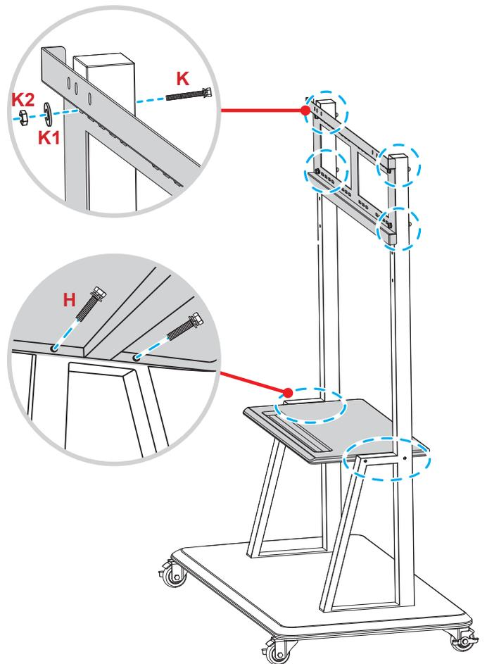
7. Alignez et accrochez les équerres de montage doubles sur le support mural installé sur les pieds du socle.
