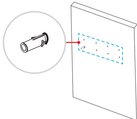
3. Positionnez le support mural sur le mur. Fixez ensuite le support mural avec huit vis **(B)** via les rondelles dans les ancrages installés sur le mur.
