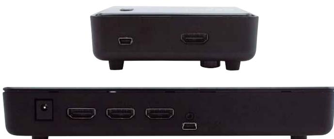
Der Transmitter (unten) nimmt zwei HDMI-Quellen an und leitet sie per Funk an den Receiver (oben) weiter, der sie wiederum per Kabel ans Ziel bringt. Im Full-HD-Kino kann das Set für aufgeräumte Übertragungsverhältnisse sorgen
