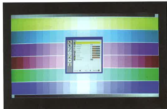
„Brillant“ bietet höhere Lichtleistung, aber auch mit zu schwachem „Rot“.
