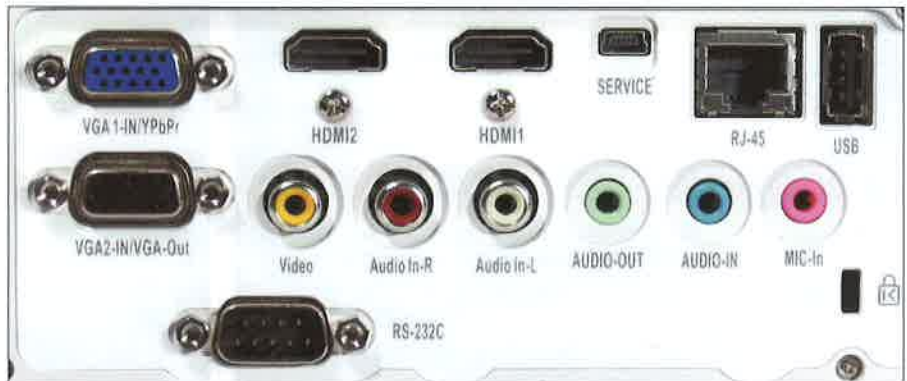
Anschlussfeld mit allen Möglichkeiten. Positionierung allerdings an der Seite, die der Bildfläche zugewandt ist.
