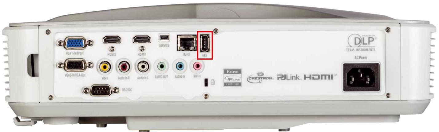
Die USB-Buchse fasst wahlweise einen Wi-Fi-Dongle oder ein externes USB-Laufwerk, ein Mediaplayer ist integriert
