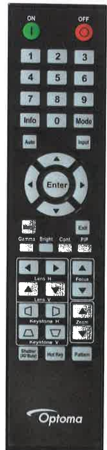
Die IR-Fernbedienung kann auch den Lens-Shift sowie Zoom und Fokus bedienen.
