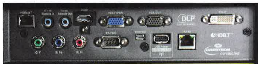
Besonderheiten im Anschlussfeld: DVI-D und HDMI, Wired Remote Ein- und Ausgang
