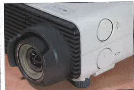
Das Festbrennweitenobjektiv hat einen schützenden Kragen, seitlich sind die beiden Stellräder für den Lens-Shift zu sehen.
